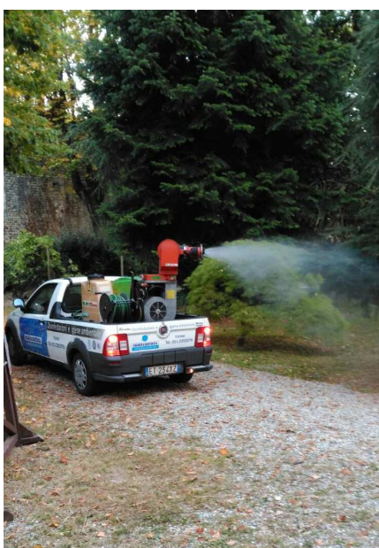
Fig. 8 - trattamenti adalticidi: mediante nebulizzatore autotrasportato, spalleggiato e rifiniture con lancia a mano.
